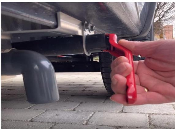
Der Ablaufbogen steht nicht über den Fahrzeugrand hinaus und die Bedienbarkeit des Absperrschiebers mit dem Aufsteck-hebel ist weiterhin gewährleistet.
