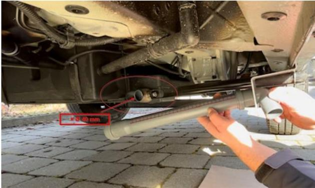
Bei den allermeisten Kastenwagen befindet sich der Schmutzwassertank unterflur vom Fahrzeugboden und dieser ist so angeordnet, dass das Ablaufventil zwar von außen mit dem Abwasserschieber bedient, jedoch optisch nicht einfach eingesehen werden kann.
