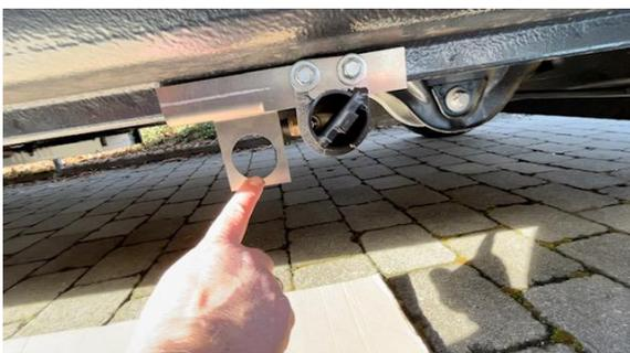
Durch die abgesetzte Aufhängung wird der Ablaufbogen mit Hilfe eines Verlängerungsrohres bis an die Fahrzeugseite des Kastenwagens verlegt.
