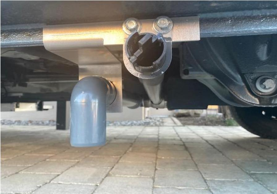
Gute Sicht auf die Position des Ablaufrohres über dem Entsorgungsschacht
