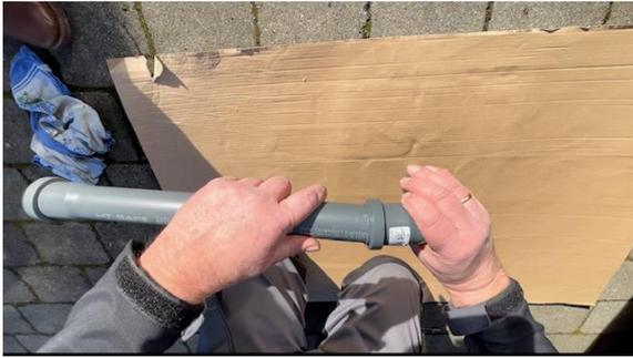
Einfache Montage -mit wenigen Handgriffen ist die Grauwasser-Ablaufaufhängung mit dem Verlängerungsrohr und Ablaufbogen am Kastenwagen montiert.
